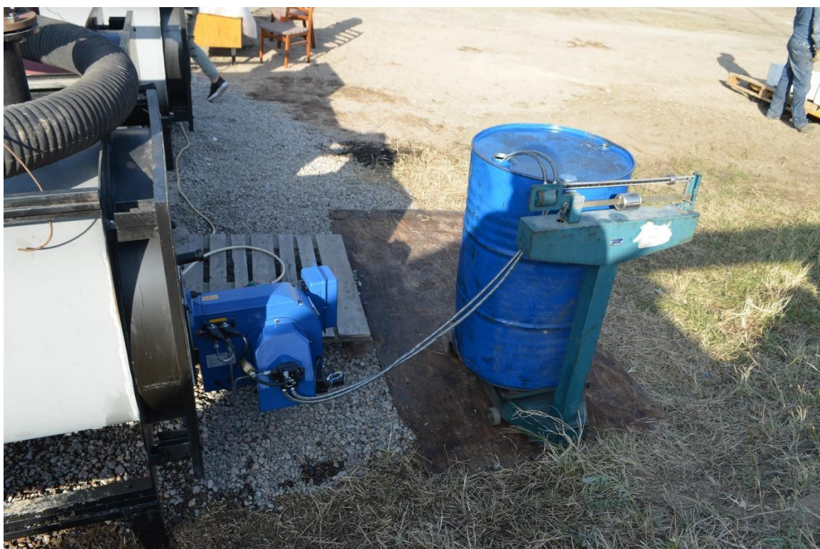
Рисунок Д.2 – Бак дизельного топлива емкостью 200 литров с указателем уровня, установленный на специализированные весы
