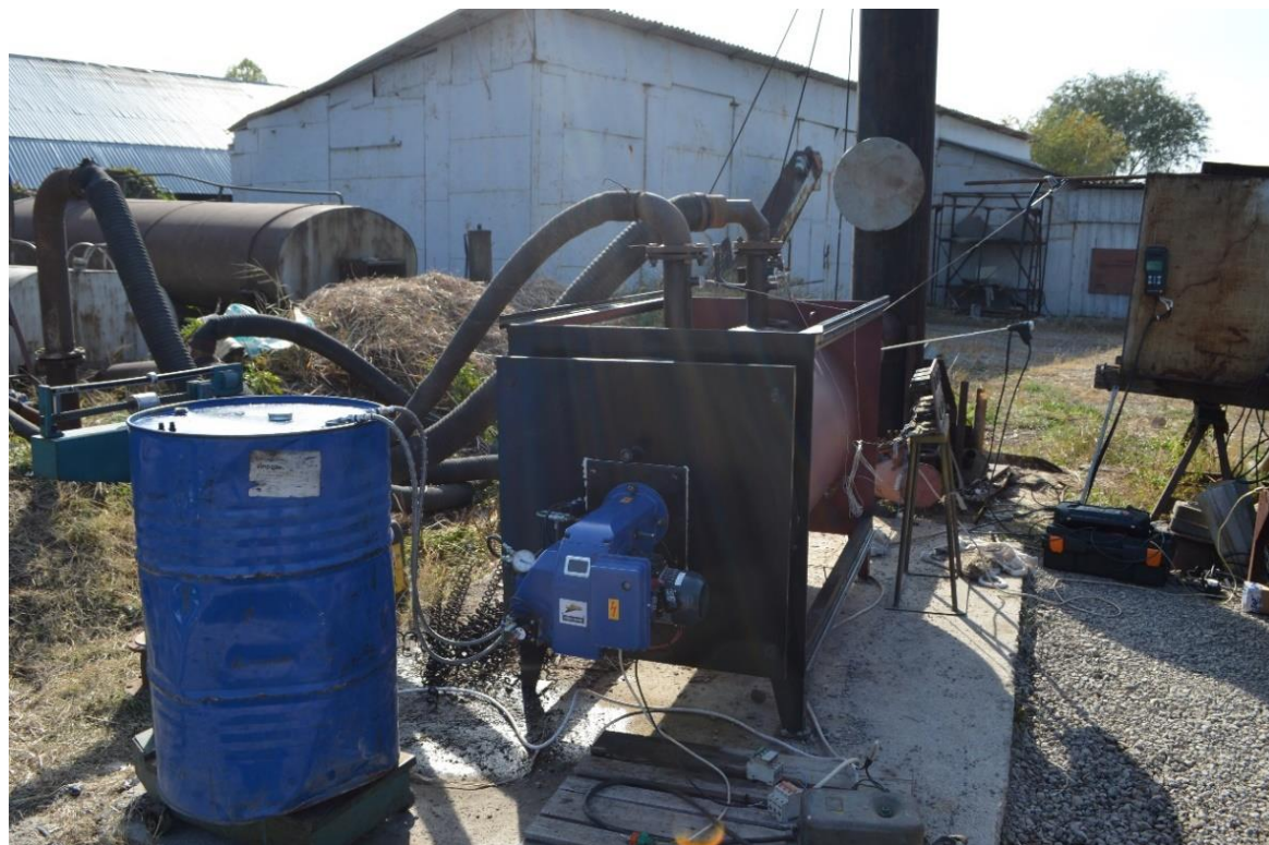
Рисунок 3.10 - Общий вид водогрейного котла ВВ-400 в период подготовки испытаний на комбинированном специальном стенде ТОО «Казкотлосервис»
