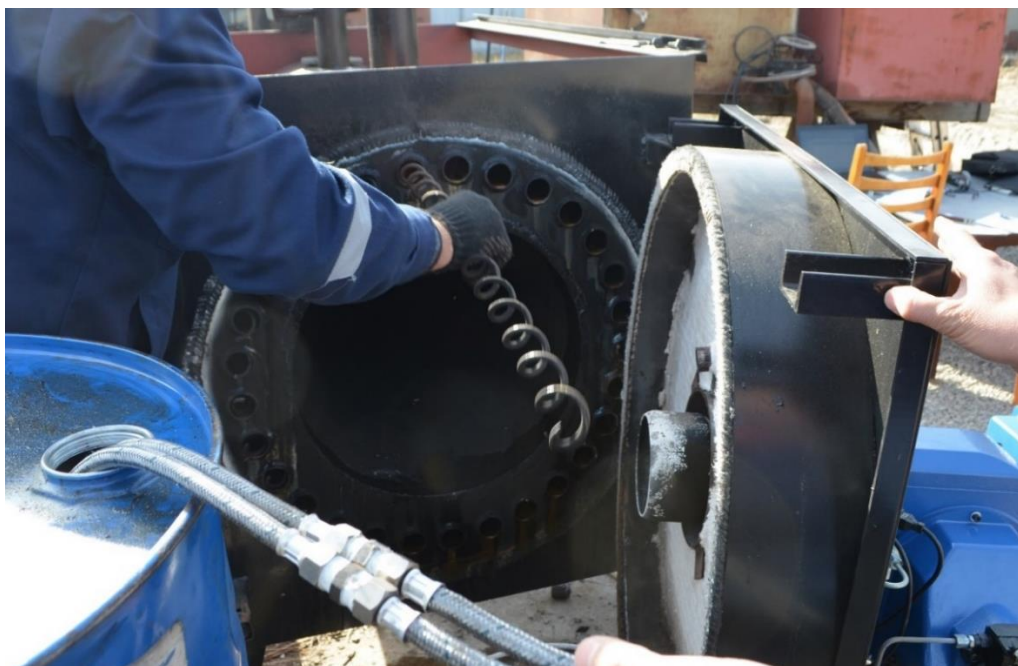
Рисунок 3.6 – Вид котла ВВ-400 с фронта на камеру горения, образующую реверсивное движение факела с конвективными трубами со спиралевидными вставками
